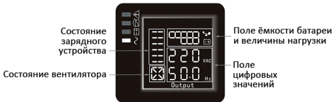
Состояние ЖК-дисплея при горизонтальной ориентации ИБП
